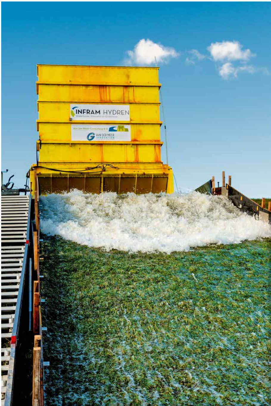
Stormsimulator tijdens een overslagproef op de Maasdijk.
