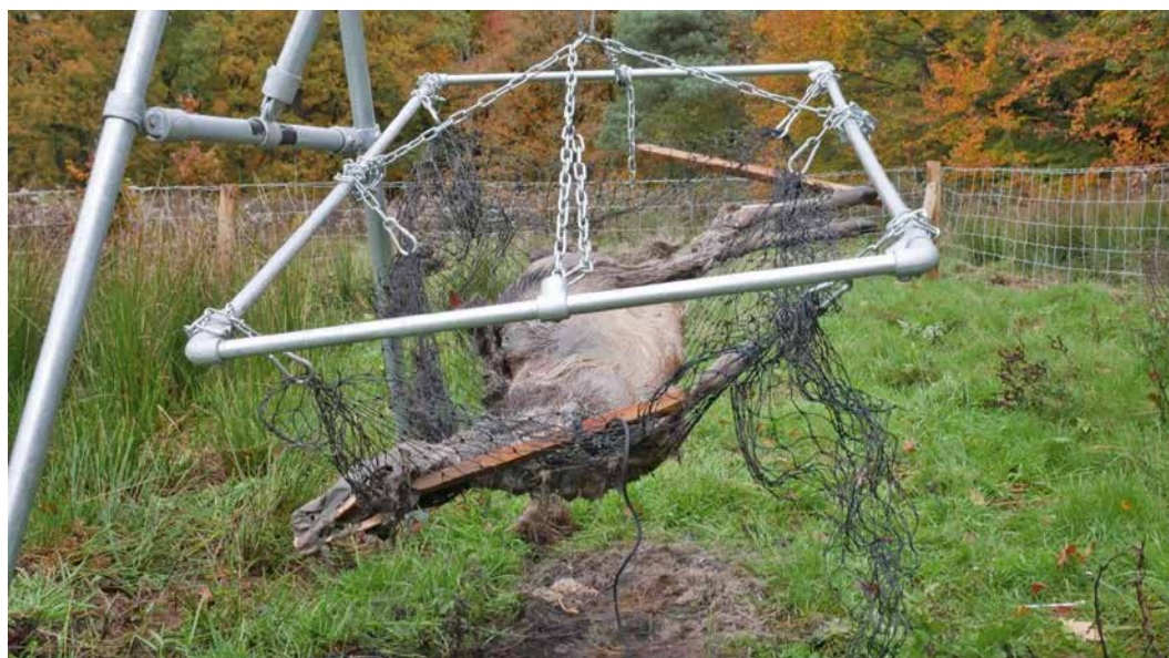
Figuur 2. Een kadaver in een tilconstructie. Op deze manier konden onder de kadavers grondmonsters worden genomen en de kadavers daarna op exact dezelfde plek worden teruggelegd.
