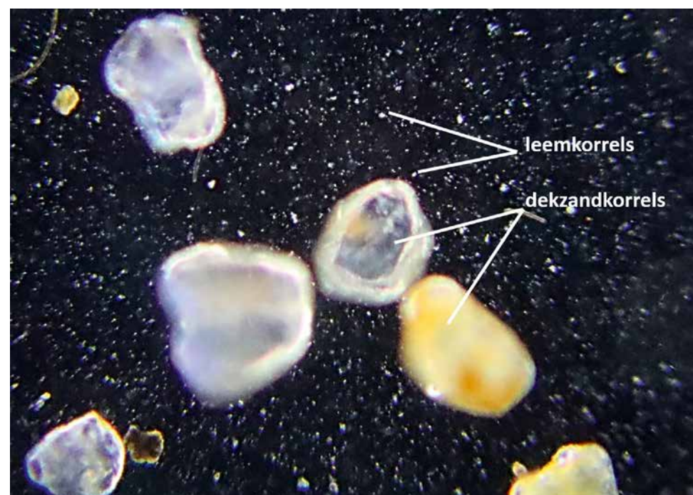
Doordat leem een veel kleine korrelgrootte heeft dan zand is het reactief oppervlak relatief groot en blijven er veel voedingsstoffen aan 'plakken'.
