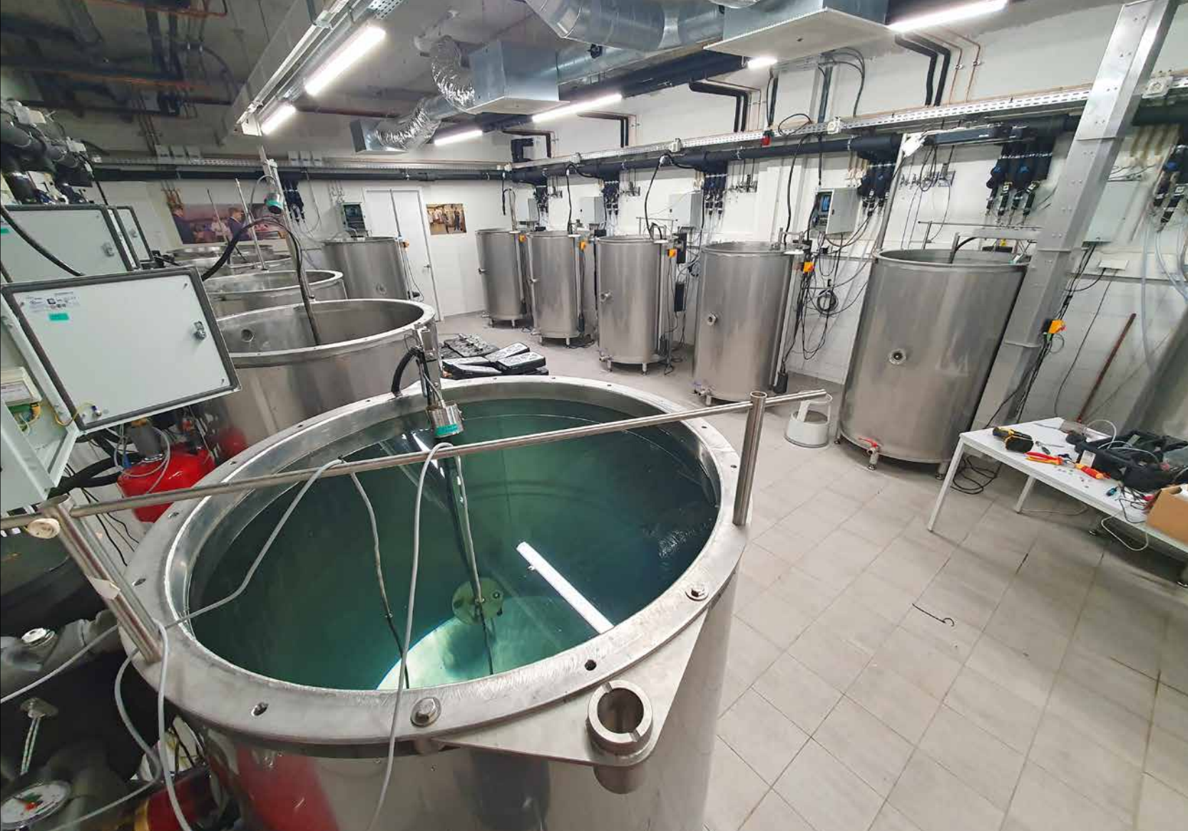
In limnotrons, mini-meren van 1000 liter, worden effecten op zoetwatersystemen getest zoals de gevolgen van klimaatverandering op blauw- of draadalg of de impact van microplastics en medicijnresten. Op dit moment bouwt het NIOO extra limnotrons met nog betere mogelijkheden om temperatuur, licht, CO 2 , waarnemingen per camera en metingen te managen.
