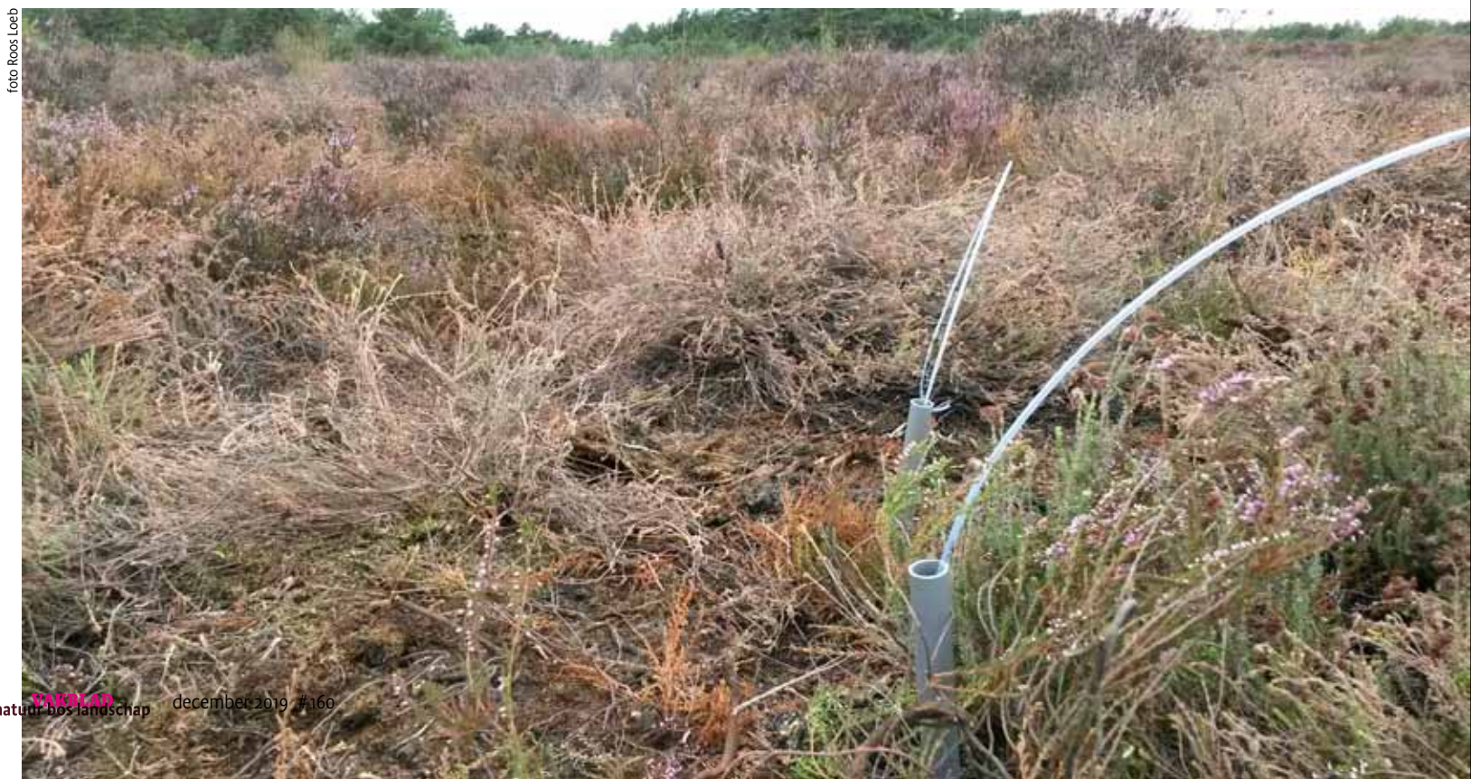
Foto 3. Beeld van de bovenzijde van de rhizonporiewatersamplers (-40/45 cm beneden maaiveld) zoals deze zijn geïnstalleerd op drie locaties met oude, ongeplagde heide (Strabrechtse heide, 14-08-2018). Duidelijk is te zien dat een deel van de heidebegroeiing flink heeft geleden onder de extreme droogte van 2018.
